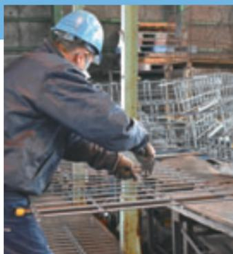
工場内での骨組みのキット化作業。これにより現場作業を大幅に効率化
