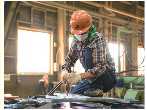
ガス溶断作業の様子(株)マルキンサトー
