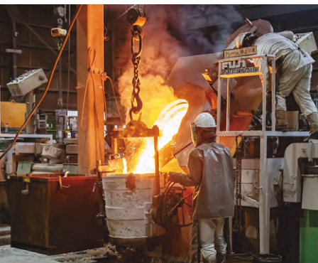
金属を高熱で溶かした「湯」は、製品ごとに適温に調整する
