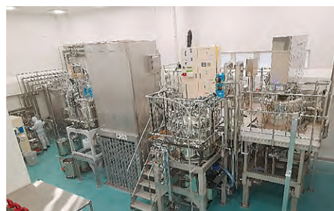
小ロットから製造可能な4基の真空乳化釜
