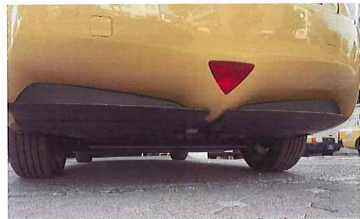
排気ガスの出ないFCEV（燃料電池自動車）のため、車両の後部には排気口も無し
