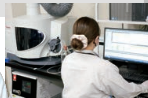
重金属(ヒ素、カドミウム、銀、水銀)の環境汚染物質を測定している様子
